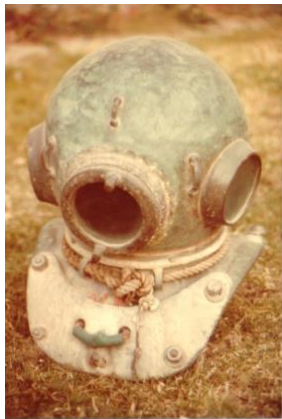
潜水用ヘルメット 下部がカスレット (Corselet)、 首周りに命綱 (Lifeline)
