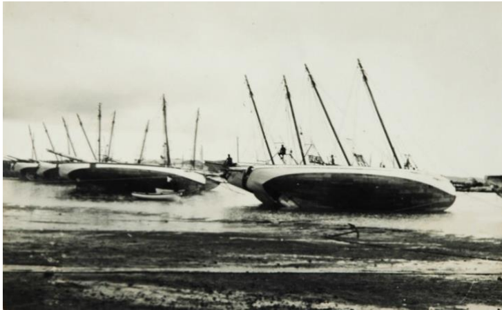
大潮時の干上がった砂浜でのダイバーボートのカバ磨り(干潮時に舷側及び船底に貼られた真鍮板(銅板)を掃除する)
