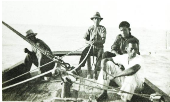
船尾で滑車を使う舵の操作
